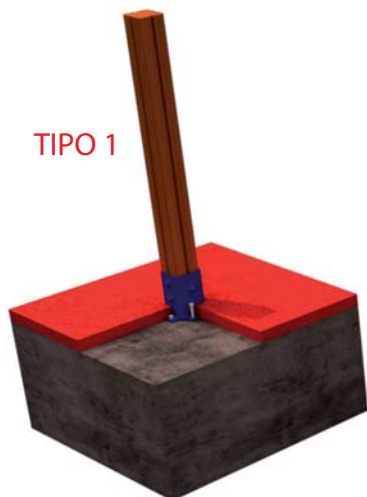
FIJACION A SOLERA DE HORMIGON
