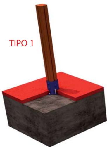
FIJACION A SOLERA DE HORMIGON
