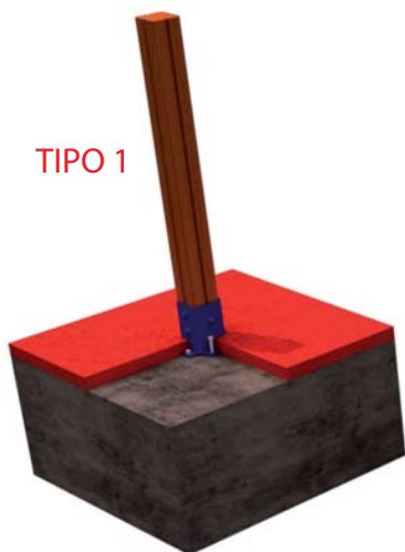
FIJACION A SOLERA DE HORMIGON
