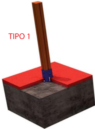
FIJACION A SOLERA DE HORMIGÓN
