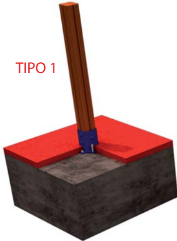
FIJACION A SOLERA DE HORMIGON
