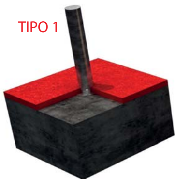
FIJACION A SOLERA DE HORMIGON
