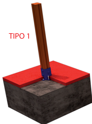
FIJACION A SOLERA DE HORMIGON
