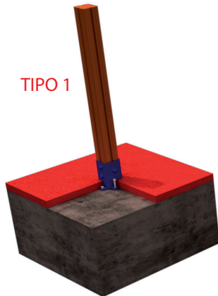
FIJACION A SOLERA DE HORMIGON
