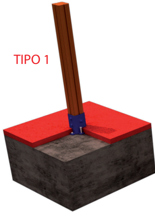
FIJACION A SOLERA DE HORMIGON
