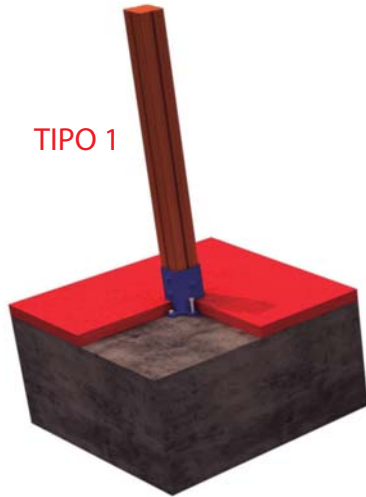
FIJACION A SOLERA DE HORMIGON
