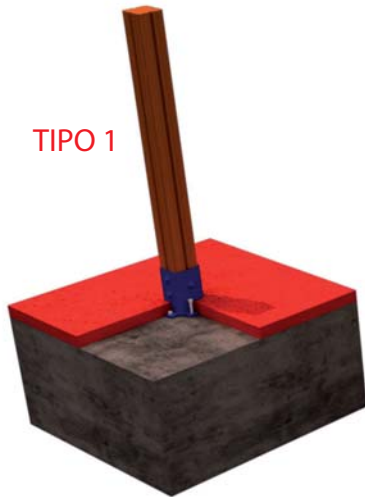
FIJACION A SOLERA DE HORMIGON
