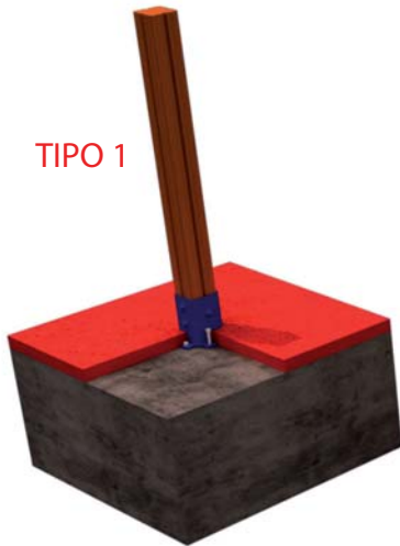
FIJACION A SOLERA DE HORMIGON
