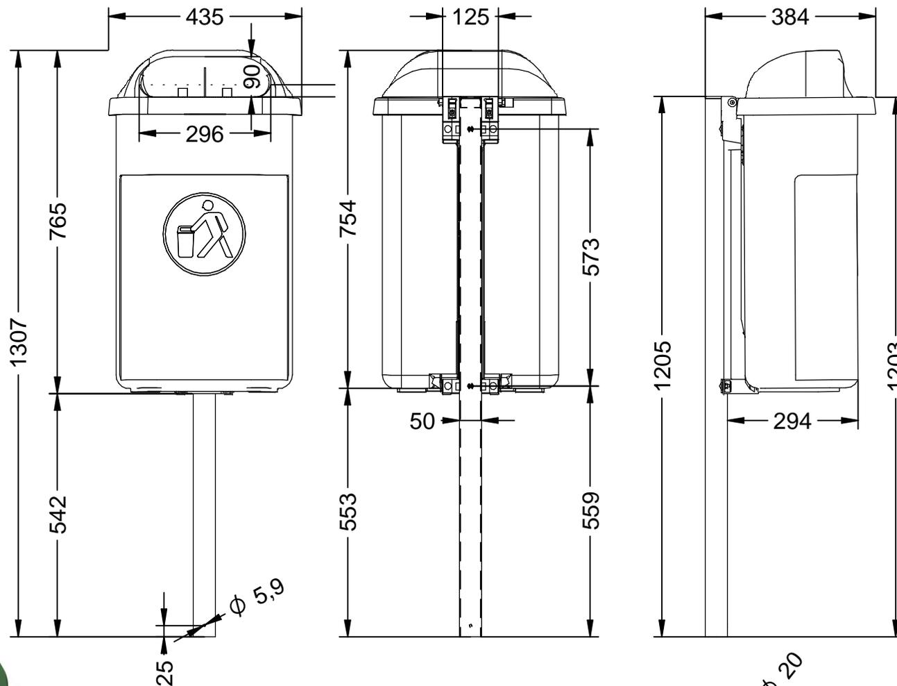
Vista de la papelera montada con el Soporte para la sujeción de la papelera al poste.
