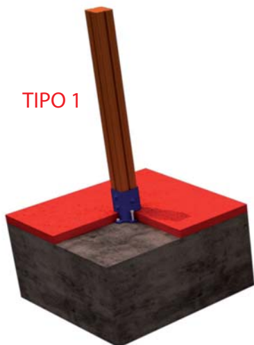
FIJACION A SOLERA DE HORMIGON
