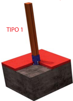
FIJACION A SOLERA DE HORMIGON
