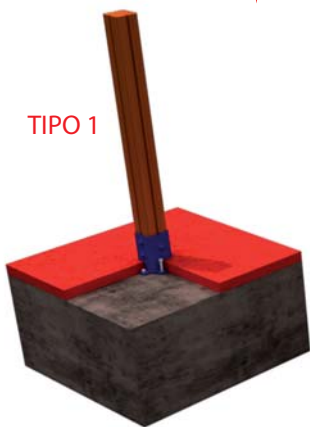
FIJACION A SOLERA DE HORMIGON
