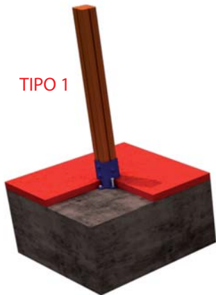
FIJACION A SOLERA DE HORMIGON
