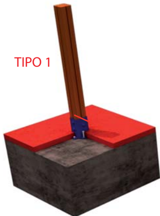
FIJACION A SOLERA DE HORMIGON
