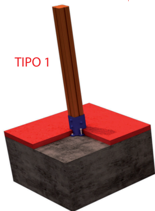
FIJACION A SOLERA DE HORMIGON
