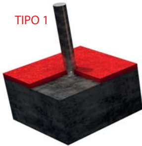
FIJACION A SOLERA DE HORMIGON
